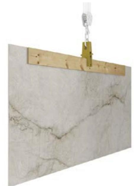
Si no se dispone de una **pinza** doble puede usarse una **sencilla**, procurando ampliar su superficie de fijación con una tabla de madera de 300 x 20 x 2 cm. Esta medida de precaución resulta imprescindible para evitar movimientos de rotación o torsiones que podrían ocasionar la rotura de las placas.
