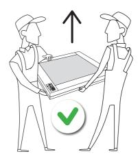
Pendant le déballage des carreaux, contrôler que le personnel ne les traîne pas par terre mais, au contraire, les manipule avec soin, en les soulevant et en les déposant délicatement au sol. Pour les formats de plus de 60x60 cm, il est préférable que deux personnes se chargent de leur manutention.
