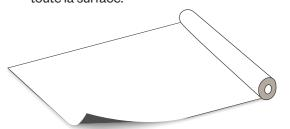
Fixer le feutre ou la bâche feutrée avec du ruban adhésif le long des bords, pour qu'aucune particule de sable ou de tout autre matériau ne passe sous la couche de protection pendant les travaux de bâtiment. Il est indispensable de contrôler de ne pas laisser de sable ni de poussières sous cette couche de protection.
