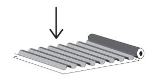
Fixer le carton ondulé avec du ruban adhésif le long des bords, pour qu'aucune particule de sable ou de tout autre matériau ne passe sous la couche de protection pendant les travaux de bâtiment. Il est indispensable de contrôler de ne pas laisser de sable ni de poussières sous cette couche de protection.
